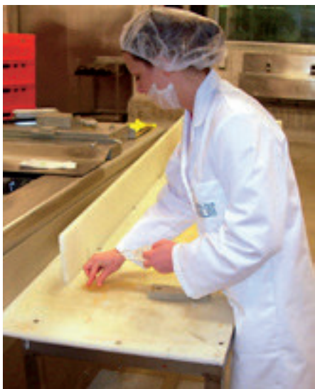
Erfassung der Oberflächenkeimbelastungen - Abklatschtest Oberfläche
